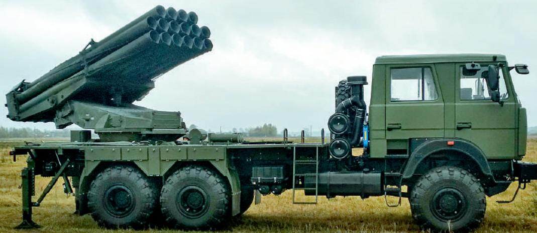
В начале июля ОАО «ВОЛАТАВТО» успешно завершило предварительные испытания боевой машины 9П140МБ РСЗО «Ураган», проведенные в рамках опытно-конструкторской работы (ОКР) по модернизации изделия.
